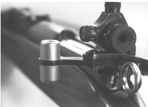
Bild 37: Linksriegel zu Karabiner 31
