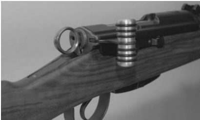
Bild 39: Riegelgriff anatomisch zu Karabiner und Langgewehr
