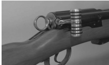
Bild 39: Riegelgriff anatomisch zu Karabiner und Langgewehr
