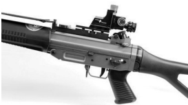
Bild 21: Diopterträger M24-N Schneider Waffen
