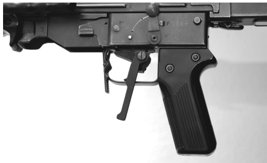
Bild 33: Winterabzug für Linksschützen zu Stgw 57
